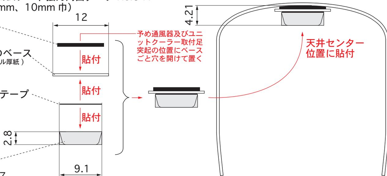
照明ユニットは端子同士が近接するよう背中合わせにしてベースに貼付けそれぞれの端子のスプリングは撤去して端子同士を図のように結線する
