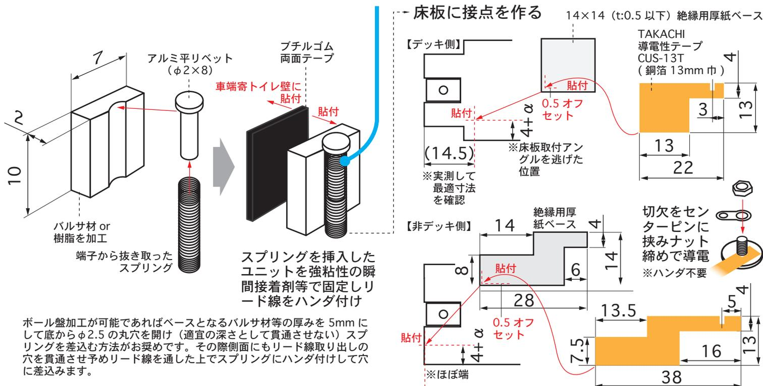
図示のspringユニットを配置したところの床板上に接点 (導電性テープ面) を設置し床板の装着で通電するようにします。尚センターピンの特に台車側の導電性が稀に劣る場合があるのでその際はセンターピンのビス頭の裏など黒染めの一部をヤスって落とすと効果的です。
